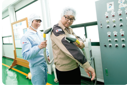
2 / 생산라인으로 들어가기 전 접촉롤러와 공기흡입기로 오염물질을 제거한다.
