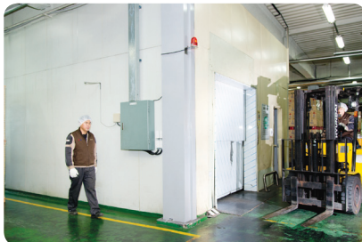
4 / 지게차 이동 구역에는 동작센서와 안전거울을 설치한다.
